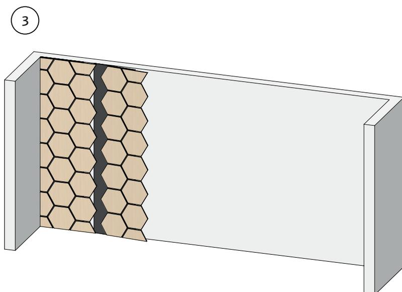
3. Vergewissern Sie sich vor der Montage der SKARV-Paneele, dass auf der bestehenden Wand keine Kleberreste vorhanden sind. Passen Sie das SKARV-Panel an und schieben Sie das letzte Stück dann so, dass die Filzteile aneinander liegen. Achten Sie darauf, die Paneele an allen Seiten an die Wand zu drücken, damit der Kleber haftet.
