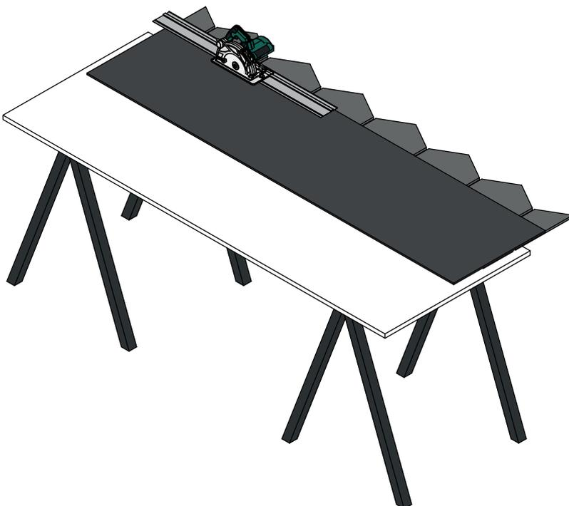
5. Verwenden Sie eine Kreissäge mit feiner Verzahnung oder eine Säbelsäge. Stellen Sie sicher, dass Sie beim Sägen einen Tisch als Unterlage verwenden, damit die Paneele flach liegen. Sägen Sie mit der Rückseite des Panels nach oben.
