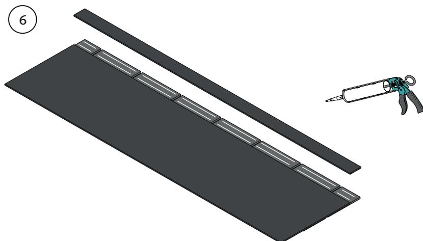
6. Sollten die Sechsecke über das Paneel hinausgehen, kleben Sie den Filz mit unserem WallRibbon-Kleber fest, bevor Sie das Paneel an der Wand befestigen.
