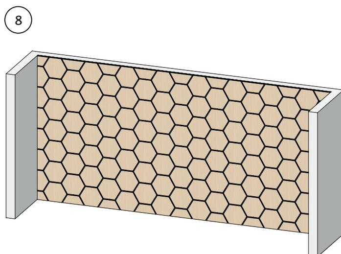
8. Wenn alle Ribbon-Hexagon-Paneele an der Wand angebracht sind. Überprüfen Sie die Verbindungsstellen, an denen die Sechsecke befestigt sind. Sollte sich ein Sechseck aus dem Filz lösen, nehmen Sie unseren Kleber und kleben Sie es bei Bedarf am Filz fest. Sollte eine Kante der Sechsecke während der Montage einen Schlag abbekommen haben, schleifen Sie die Kante mit Schleifpapier.
