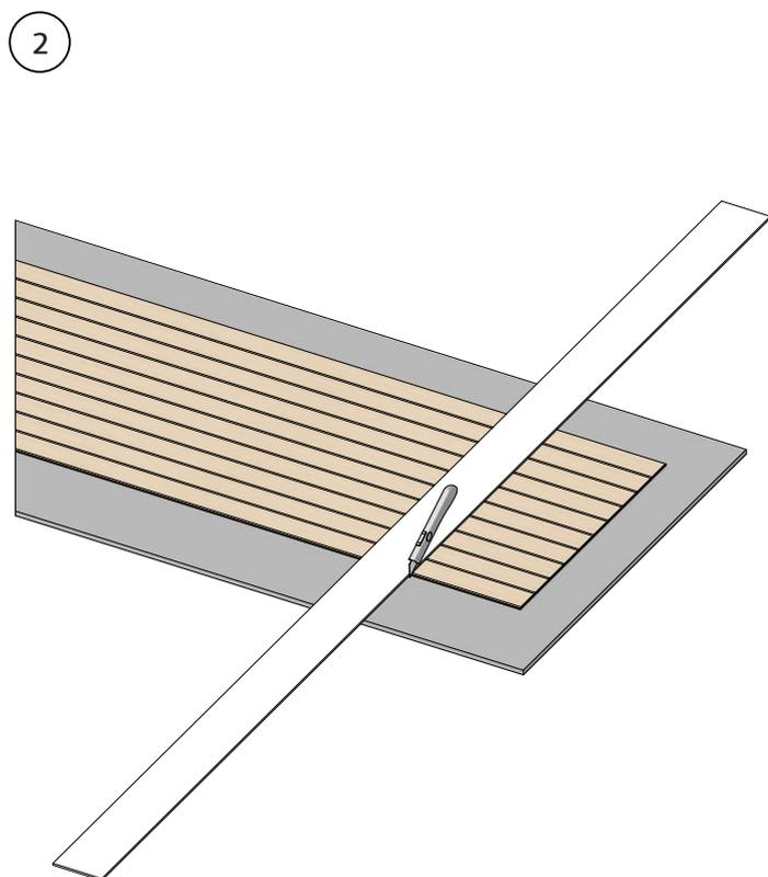
2. Wenn die Paneele auf die richtige Höhe zugeschnitten werden müssen, verwenden Sie das ThinRibbon-Messer mit unserem Lineal. Um die gesamte Dicke des Paneels zu durchschneiden, schneiden Sie wiederholt in dieselbe Nut. Wechseln Sie die Klinge regelmäßig.
