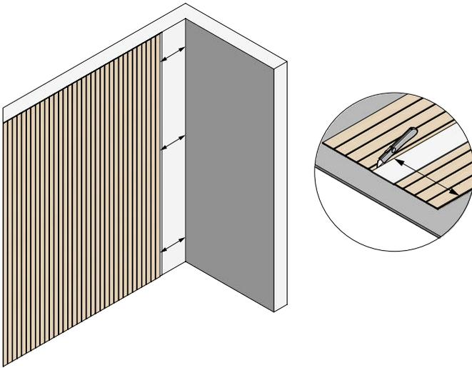
5. Messen Sie vor dem letzten Stück die Breite zwischen dem Paneel und der Wand an mindestens drei verschiedenen Stellen, um sicherzustellen, dass das Paneel passt. Verwenden Sie das ThinRibbon-Lineal zum Zeichnen einer geraden Linie und als Unterstützung beim Schneiden des Paneels mit unserem Messer. Schneiden Sie mehrmals, um einen sauberen Schnitt zu erhalten.
