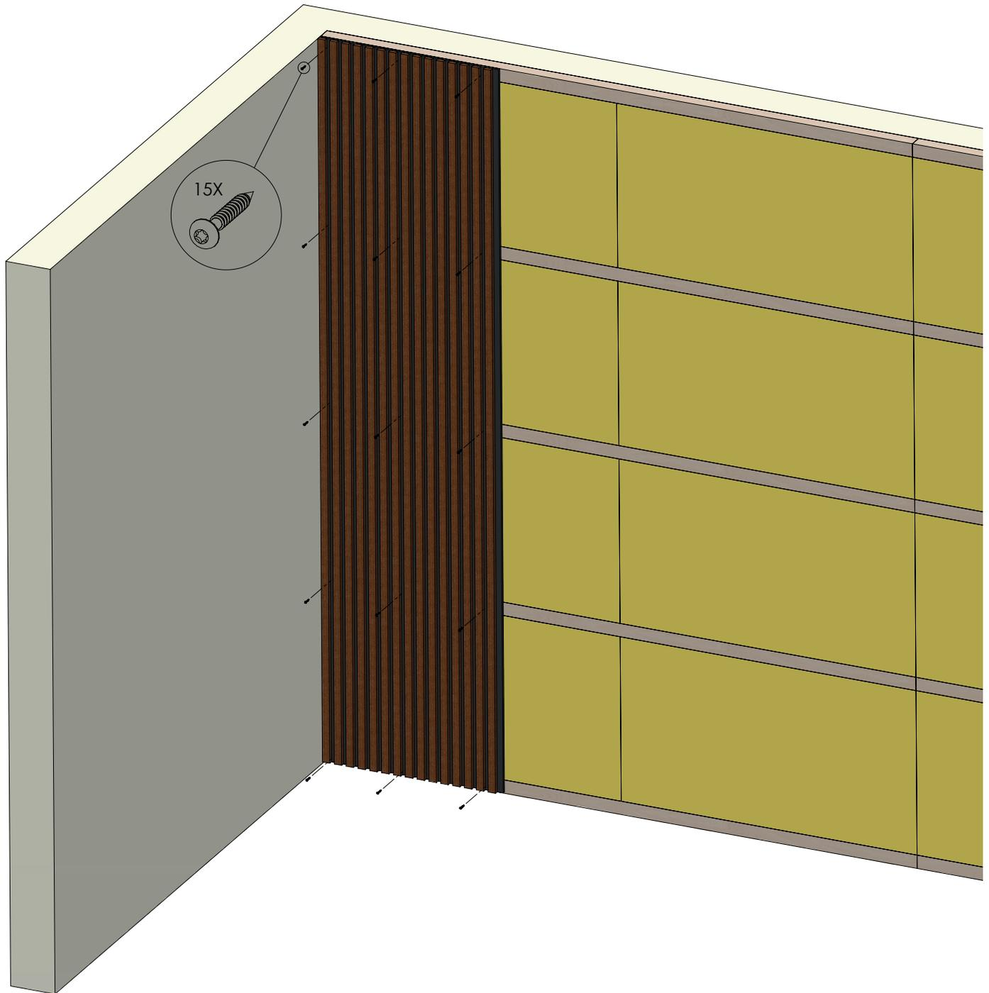
Es gibt verschiedene Möglichkeiten, unser Ribbon-Wood zu montieren. Sie können die Paneele an vorhandene Wände / Decken schrauben oder kleben.
